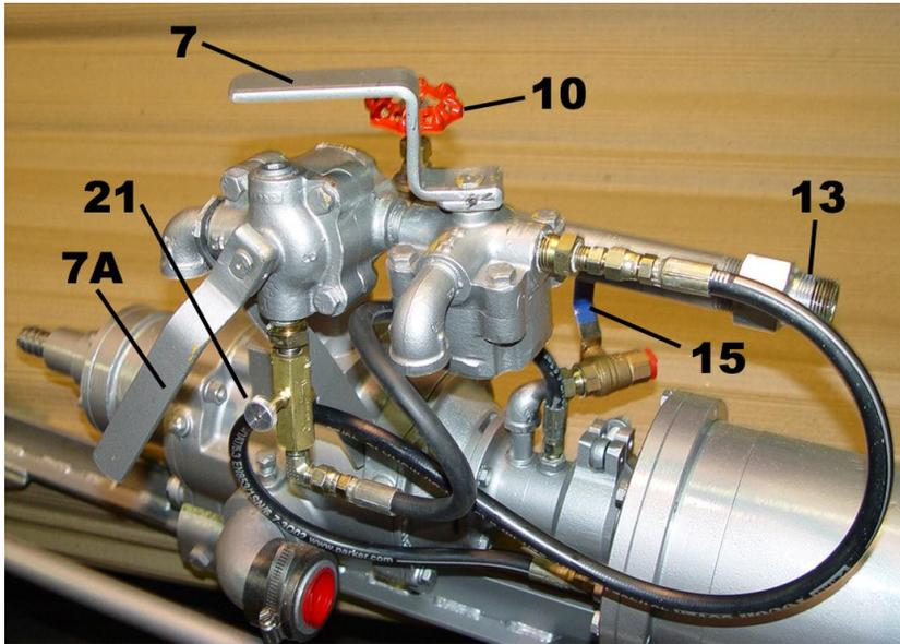
**7A** DIRECTIONAL CONTROL VALVE SHOWN IN THE REVERSE FEED RETRACT POSITION.
