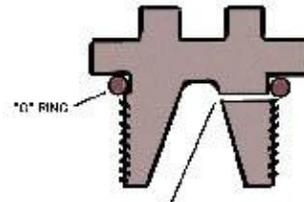
HOLE DRILLED FROM INSIDE OF FILLER CAP
