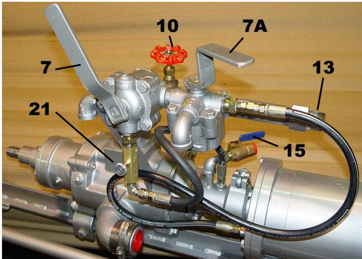
**7A** DIRECTIONAL CONTROL VALVE SHOWN IN THE FORWARD FEED DRILLING POSITION.
